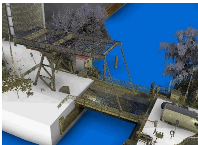
Abbildung 4 - Holzhafenklappbrücke Punktwolke (Quelle: LSBG / LGV)
